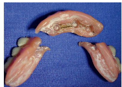
Abbildung 5c Bruch der „nicht-Gerüst“ unterstützen Prothese. Figure 5c Fracture of dentures without framework support.
