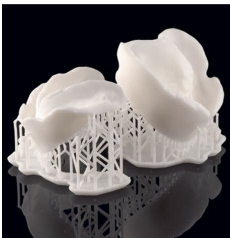
**Abb. 1** 3-D-gedruckte Löffel mit Bisswällen.
