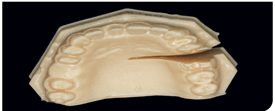
Abb. 7 Fehldruck eines Modells: durch das Lösen des Modells von der Bauplattform entstandene Verzerrungen und ein Einriss (ZT: Jennifer Weininger; Foto: Anke Sauer).
