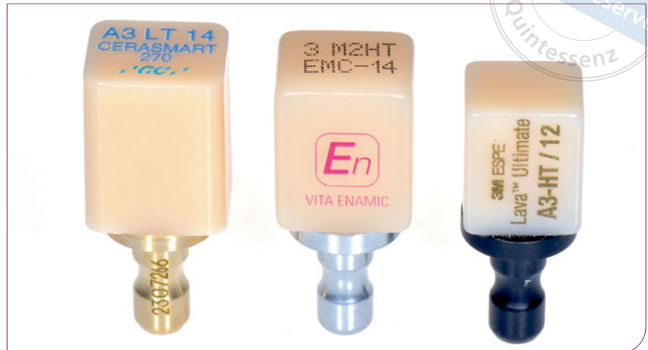
Abb. 2 Exemplarische Darstellung verschiedener fräsbarer CAD/CAM-Polymere, von links nach rechts: Cerasmart 270 (GC Corporation, Tokyo, Japan), Vita Enamic (Fa. Vita Zahnfabrik H. Rauter GmbH & Co. KG, Bad Säckigen), Lava Ultimate (3M Corporation, Minnesota, Vereinigte Staaten).
