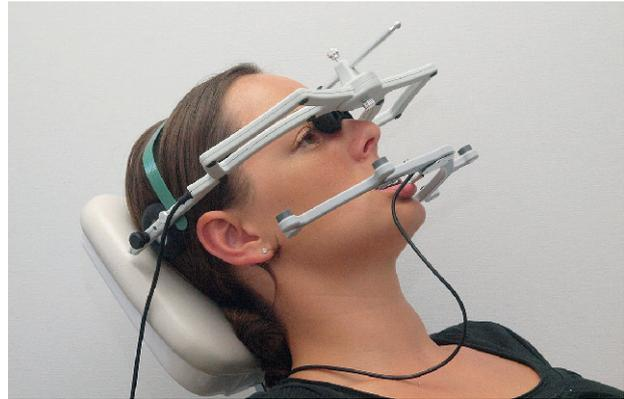
**Abbildung 2** Beispiel für ein okklusionsebenennah und berührungslos messendes System zur Bewegungsaufzeichnung des Unterkiefers (hier: Jaw Motion Analyser JMA, Fa. Zebiris Medical)
