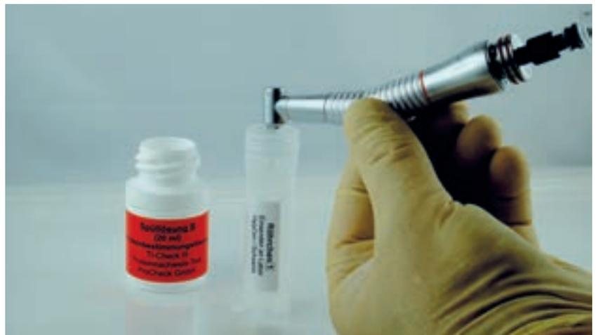
**Abbildung 1** Spülung eines Winkelstücks mit SDS-Lösung zur Gewinnung der Elutionsflüssigkeit für die Bestimmung des eluierbaren Proteingehalts aus dem Inneren des Übertragungsinstrumentes.
