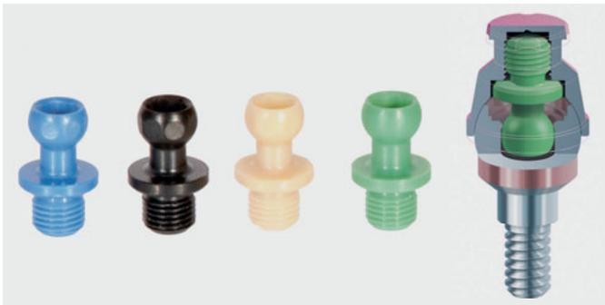
**Abb. 17** Die vier in ihrer Retentionskraft unterschiedlichen Befestigungskugeln (blau = 22,5 N Abzugskraft; schwarz = Bearbeitungskugel; beige = 44,45 N Abzugskraft; grün = 88,29 N Abzugskraft). Das Gewinde wird in die im Gerüst verklebte Matrize geschraubt (s. rechte Grafik). Die Kugel (Patrize) rastet im Locator-Abutment ein (Bild: SIC).
