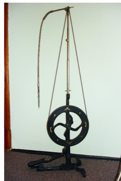
Abbildung 1 Von Morrison 1871 aus einem Spinnrad entwickelte Tretbohrmaschine.
