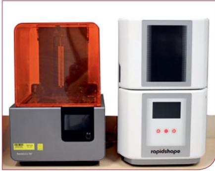
**Abb. 2** Beispielhafte Darstellung zweier DLP-/SLA-Drucker (links: Form 2, Formlabs; rechts: D20 II, Rapidshape).
