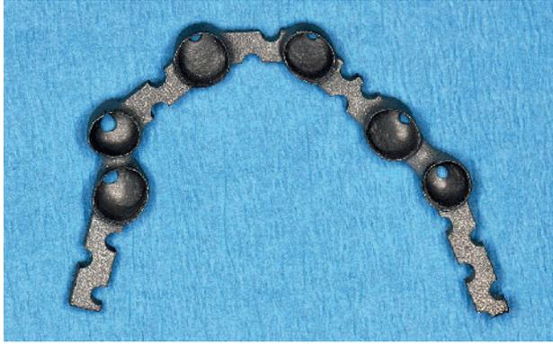
**Abbildung 2.5** Tertiärgerüst, hergestellt durch selektives Laserschmelzen
